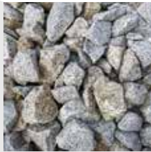
Concassé granit gris mélangé
